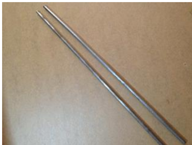
شفت مورد استفاده در کمیکار آموزشی با قطر ۴ میلی متر
